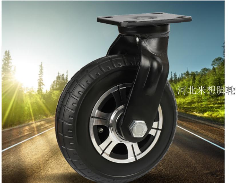
在使用脚轮时，希望预先考虑其使用方式，所需功能，使用的条件（使用范围），然后选用合适的类型，请注意以下事项：适当的承重负荷产品介绍的可能承重负荷是指用人工操作在平坦的地面上搬运时易于移动的一般承重，同时是能在安全状态下长期进行此类搬运工作的一般性负荷，事先需要估算一下运载物件的总重量，然后按所允许的负重选择合适的脚轮。通常会出现在4只脚轮中只有3只受力的情况，故总重量的限重应以理论\*0.8为妥（即不要计算的太满）。用4只脚轮时，总重量的限度=每只（1只）脚轮的允许承重负荷\*4\*0.8，混合使用不同尺寸规格脚轮时，请以比较低的承重负荷的那一种脚轮为基准，算出整体最大承重量。河北米想脚轮值得推荐。欢迎来电咨询河北米想脚轮！河北聚氨酯脚轮价格
